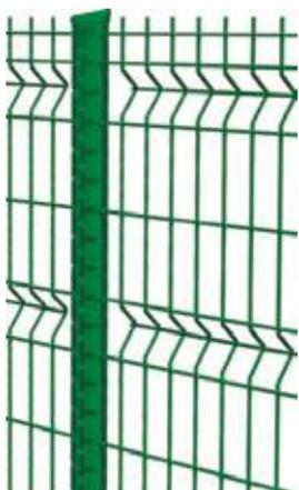
La clôture BASTIECO® est un système complet breveté indémontable. Les panneaux en treillis soudés BASTIECO® sont composés de mailles rectangulaires en fils d'acier galvanisé plastifié, et de fils de diamètre 4 mm.
