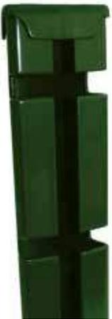
Le poteau BASTIFOR® de forme triangulaire avec encoches tous les 100 mm possède un chapeau métallique clipsé avant thermolaquage (sauf 3.10 m et 3.50 m) et permet la pose en redans même sur les terrains les plus accidentés.
