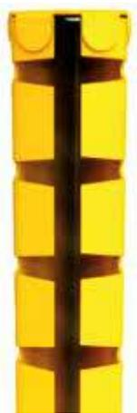
Le poteau BASTION® de forme triangulaire avec encoches tous les 50 mm possède un chapeau métallique clipsé avant thermolaquage et permet la pose en redans même sur les terrains les plus accidentés. Pour les angles supérieurs à 80°, un seul poteau suffit.
